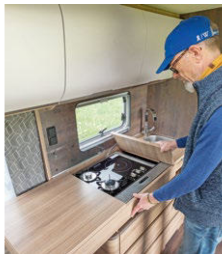
Innovative Küchenlösung: Das Kochfeld, hier in Hybrid-Ausführung mit Gas und Induktion, ist vollständig unter der Arbeitsplatte versenkbar.
