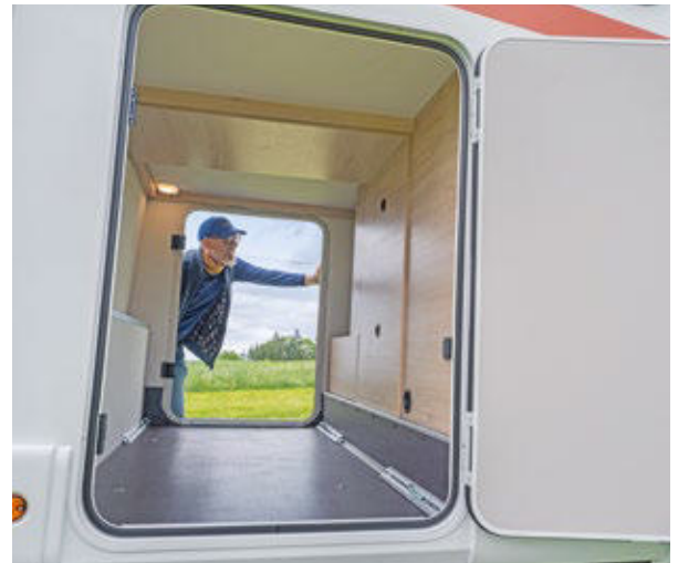
Oben: um 6 Zentimeter auf 1,10 Meter vergrößerte Garagentüren. Unten: ausziehbare Multifunktionsstufen als Bettzugang und Stauraum.
