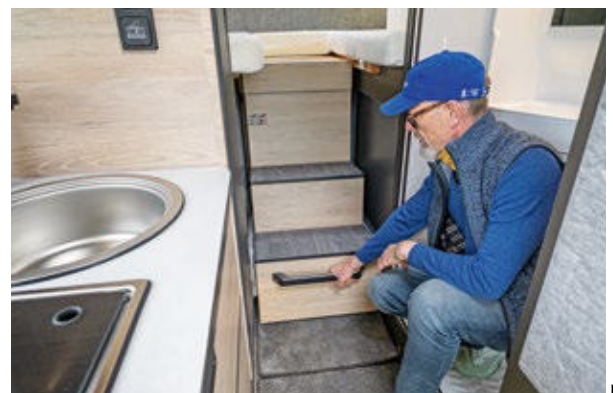
Oben: um 6 Zentimeter auf 1,10 Meter vergrößerte Garagentüren. Unten: ausziehbare Multifunktionsstufen als Bettzugang und Stauraum.
