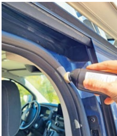
Tipp: Neben sichtbaren Dichtungen gibt es auch unscheinbare Stellen, die ab und zu Pflege vertragen können ...
