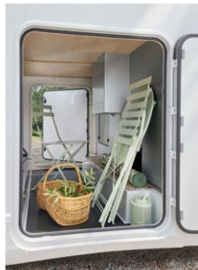
Groß und geräumig: Die Garage ist beidseitig beladbar und mit Aluschienen und Zurrösen bestückt.
