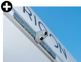
Die optionale Rückfahrkamera liefert ein scharfes Bild ans Radio-Display.
