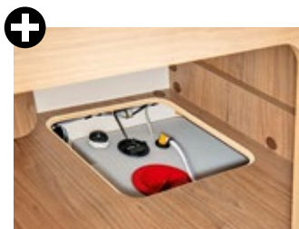
Der frostgeschützte Frischwassertank ist im Kleiderschrank gut zugänglich.
