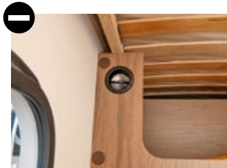
Der Heizungsausströmer der Garage ist hoch unterm fahrerseitigen Bett platziert.
