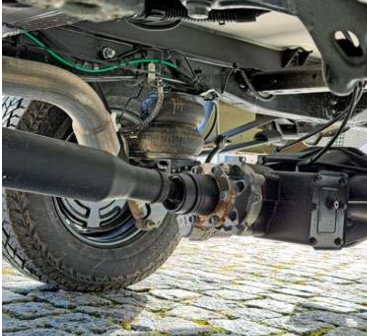
Das Elektro-Setup ist umfangreich – und ordentlich beschriftet, was eine mögliche Fehlersuche erheblich vereinfacht. Links: Hinterachs-Diff und die Zusatz-Luftfeder zur Auflastung auf 4,2 Tonnen.
