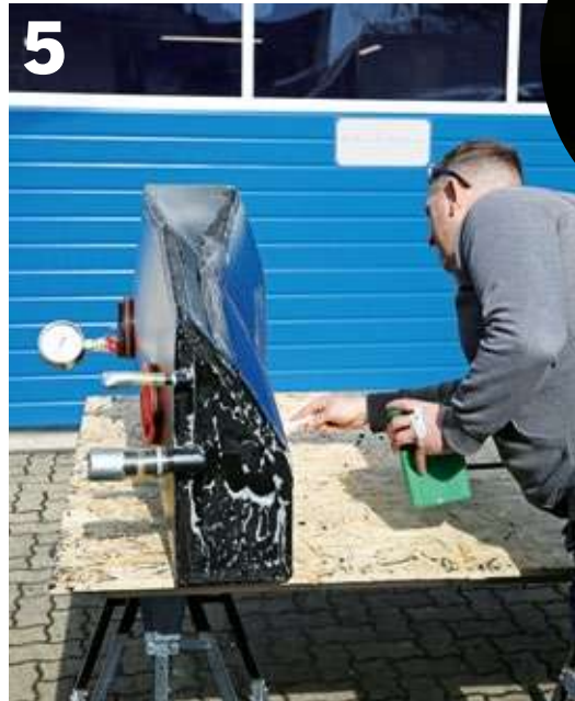
Alles dicht? Jeder Tank wird vor der Auslieferung gewissenhaft auf Dichtigkeit geprüft.
