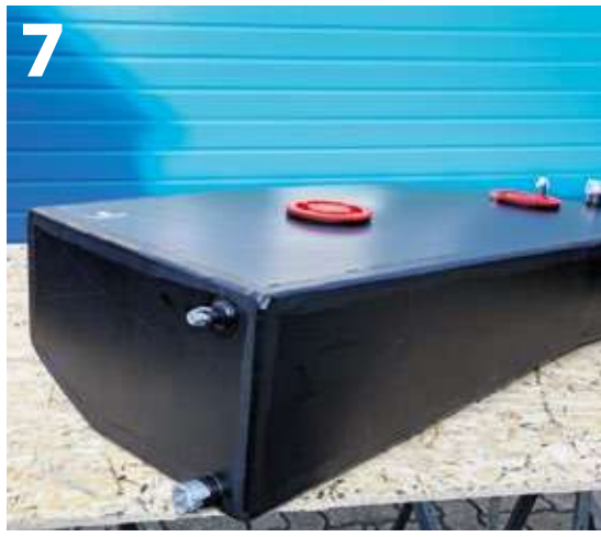
7 Der fertige Tank: Kunden können sich auch Winkel zur einfacheren Montage anschweißen lassen.
