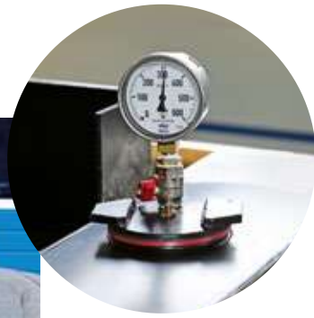
Alles dicht? Jeder Tank wird vor der Auslieferung gewissenhaft auf Dichtigkeit geprüft.
