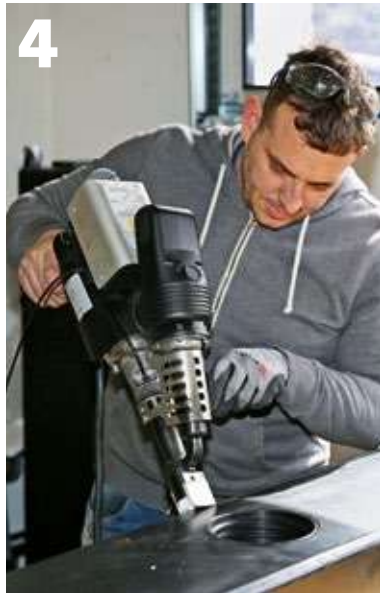
4 Jetzt gilt es: Alle Einzelteile und/oder Fittings und Muffen werden präzise zusammen- oder eingeschweißt.
