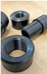
Hohe Fertigungstiefe: Schäfer dreht Muffen und Tüllen exakt auf Maß in der eigenen Werkstatt.
