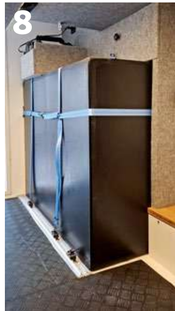
Im Idealfall fixiert man größere Tanks noch spielfrei mit robusten Winkeln (Profilen) oder Schienen.
