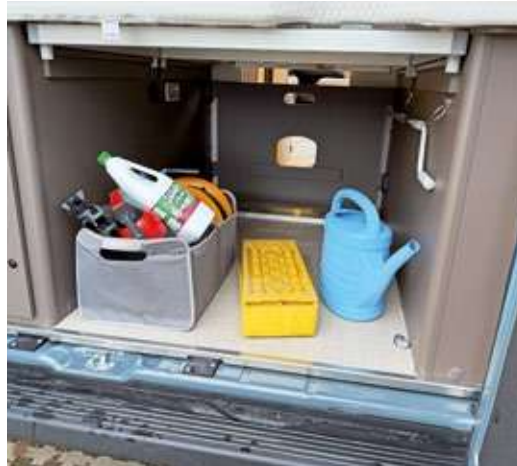
145 mal 92 mal 69 Zentimeter misst die klassenübliche Heckgarage. Vier Zurrösen sind ab Werk serienmäßig verbaut.
