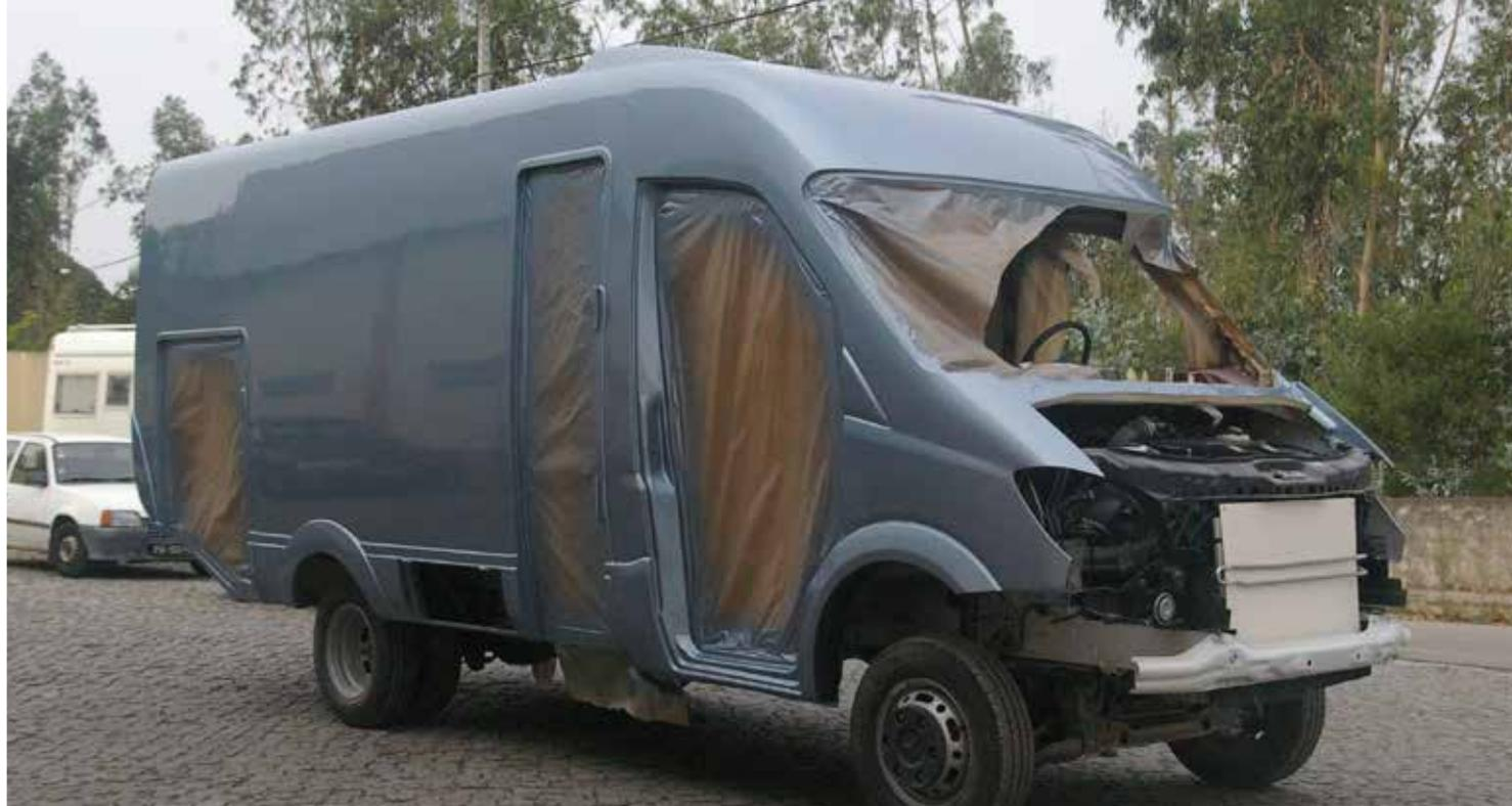
Als weltweit einzige Reisemobilmarke fertigt Starliner alle Reisemobile ausschliesslich in der Monoshell Technik. Ähnlich wie ein Bootsrumpf besteht der gesamte Aufbau aus einer einteiligen GFK-Form. Keine Nähte und Fugen, keine Quietschgeräusche und eine mehr als 30% höhere Verwindungssteifigkeit sind dem Endprodukt somit gesichert.
